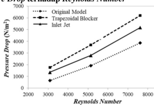
Gambar 11. Grafik Pressure Drop fungsi *Reynolds Number* pada masing-masing Modifikasi *Inlet Header*.
