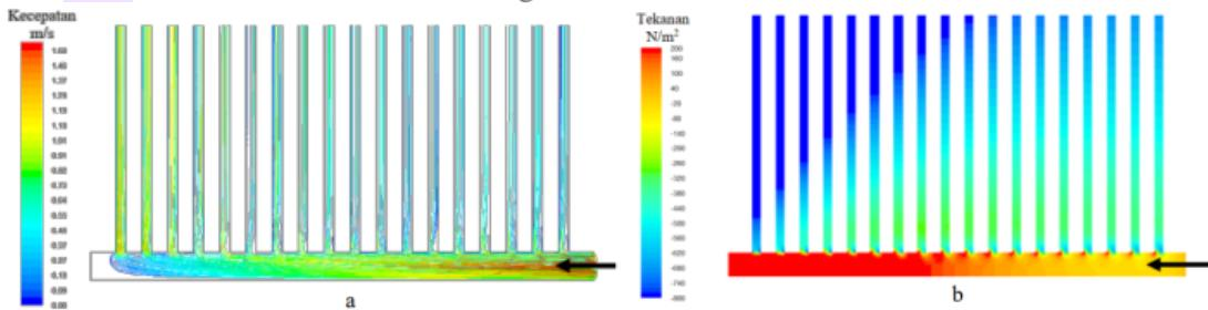
Gambar 6. Iso-surface a) Pathline Kecepatan, dan b) Kontur Tekanan pada inlet header Original model dengan Reynolds Number 5146.
