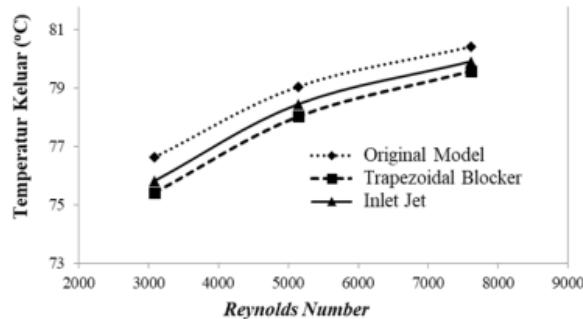
Gambar 10 Grafik temperatur keluar *lube oil* fungsi *Reynolds Number* pada masing-masing modifikasi *inlet header*
