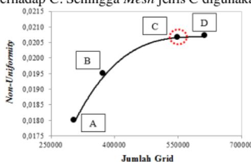
Gambar 4. Grafik Non-Uniformity fungsi Jumlah Grid pada model *original model*.
