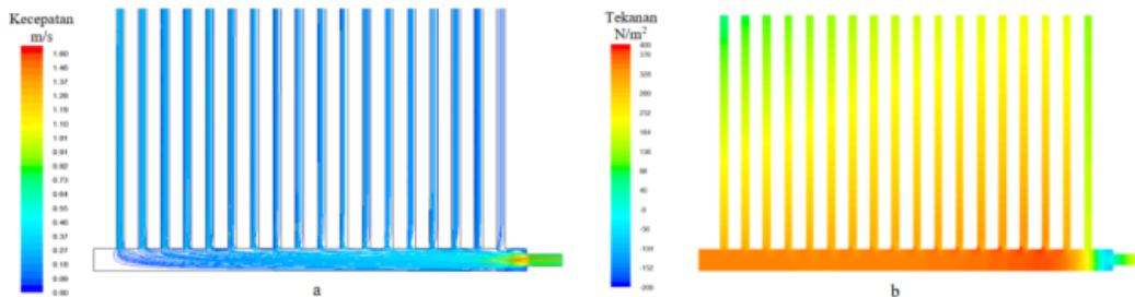
Gambar 8. Iso-surface (a) Pathline Kecepatan, dan (c) Kontur Tekanan pada *inlet header inlet jet* dengan *Reynolds Number* 5146.
